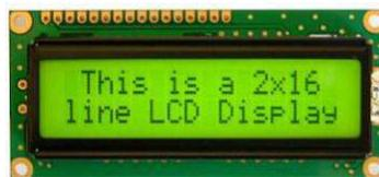
Gambar 9. LCD 16x2
