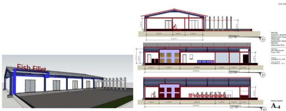
Gambar 4. DED industri Fish Fillet dengan kapasitas 1 ton per hari
